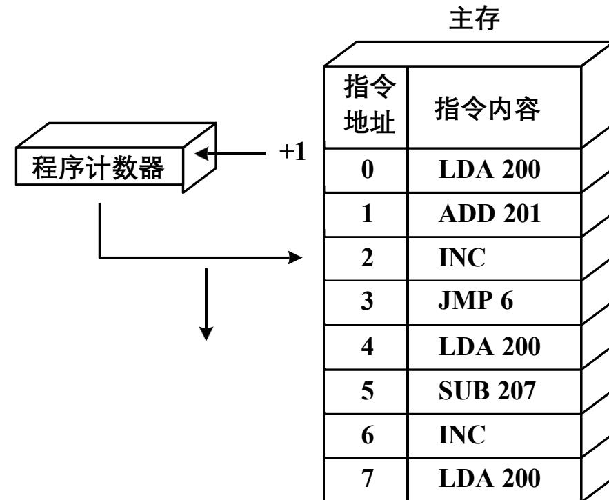
**跳跃寻址方式：**下条指令的地址码不是由程序计数器给出，而是由**本条指令**给出。程序跳跃后，按新的指令地址开始顺序执行。程序计数器的内容也必须相应改变。采用指令跳跃寻址方式，可以实现**程序转移或构成循环程序**。
